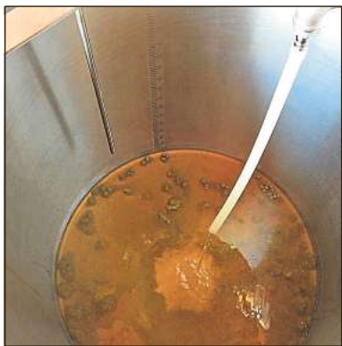
Beim Läutern wird der Treber (feste Maischebestandteile) von der Würze (flüssige Maischebestandteile) getrennt.
